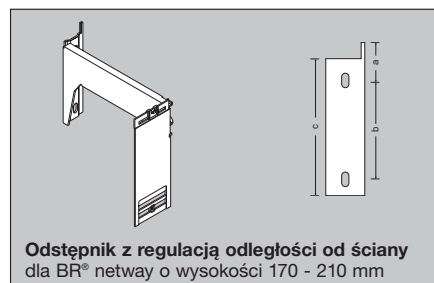
Odstępnik z regulacją odległości od ściany dla BR® netway o wysokości 170 - 210 mm
